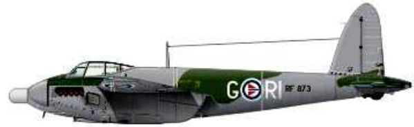
Mosquito FB Mk.VI ASH, 334º Esquadrão, Sola, Noruega, 1951. Em 1949, dois Mosquitos foram transformados em caças noturnos com a instalação de um radar AN/AP 34 no nariz.
