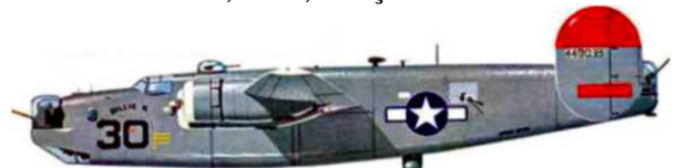
B-24M "Billie K", 765º Esquadrão, 461º Grupo de Bombardeiros, Itália, 1945. Este aparelho é pintado de Blue Gray, cor normalmente usada nos "pathfinders" da 15ª Força Aérea, e é equipado com o "radar Mickey".
