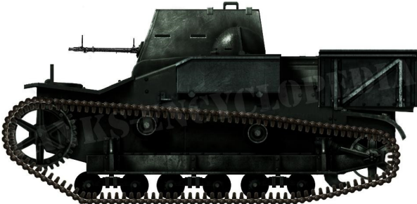
Gepanzerte-MG-Träger Renault UE(f) de uma unidade da Luftwaffe. Este exemplar foi armado com uma MG 34 e contava com um compartimento do metralhador maior que o anterior.
