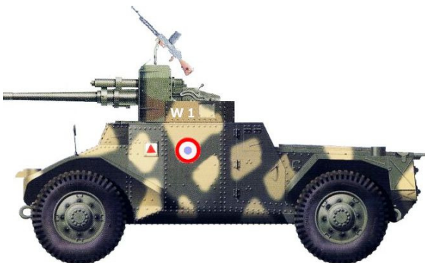
Protótipo de caçatanques, armado com um canhão AT SA 37 de 47 mm, 10/07/40.
