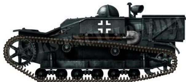
UE-Schlepper 630(f), Grécia, abril de 1941. A configuração original do Chenillette foi a mais utilizada pela Wehrmacht e com as mesmas funções. Ele era usado para rebocar os canhões Pak 36 de 37 mm, Pak 38 de 50 mm, Pak 39/40/41 de 75 mm e Pak 36(r) de 76,2mm.
