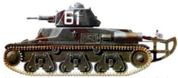
H-35 modifié 39 , unidade não identificada. A pintura é de verde oliva e castanho, sem contornos. Este veículo é dotado de “cauda de travessia”.
