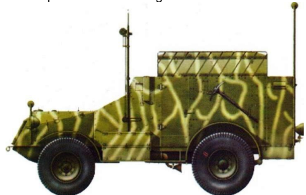
Panhard 179 convertido a carro de comunicações, ostentando pintura de verde água sobre o verde oliva.
