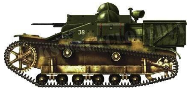
Chenillette UE mle 1931, protótipo armado construído para atender a uma encomenda da China, março de 1936. Uma pequena superestrutura foi adicionada, onde foi instalada uma metralhadora de 7,7mm numa montagem de bola.
