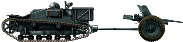
UE-Schlepper 630(f), rebocando um Pak 36 de 37 mm. A munição era estocada numa caixa atrás do compartimento da tripulação.
