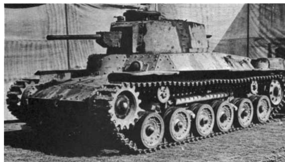
Tanque Médio Tipo 97 “Shinhoto Chi-Ha”. Armado com um canhão antitanque de 47 mm e com uma blindagem máxima de apenas 25 mm, era o melhor tanque do arsenal japonês na Manchúria.
