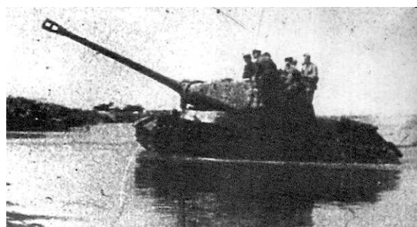
Tanque pesado JS-2, armado com canhão de 122 mm e com blindagem máxima de 120 mm. Os japoneses não tinham absolutamente nada para enfrentá-lo.
