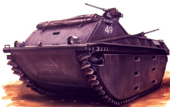
LVT-1, 2º Batalhão de Tratores Anfíbios do USMC, Tarawa, novembro de 1943. Observe as placas de blindagem adicionais especialmente adaptadas para a invasão de Tarawa.
