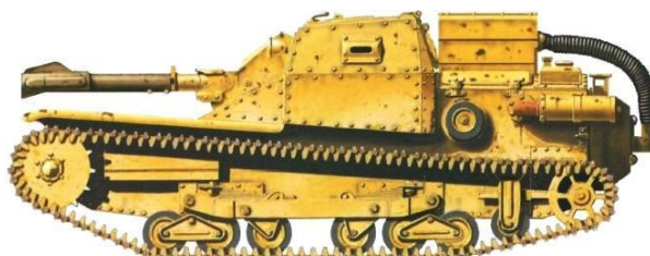
L3/35 Lança-chamas com reservatório acoplado, Cirenaica, 1942.
