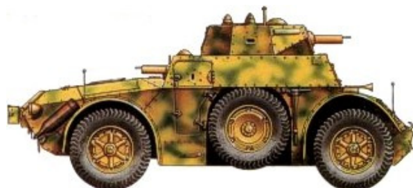
AB 40, unidade ignorada. Apenas 24 AB 40 foram produzidos e a maioria foi convertida a AB 41 pela substituição da torre (seu armamento original era um par de metralhadoras de 8 mm).
