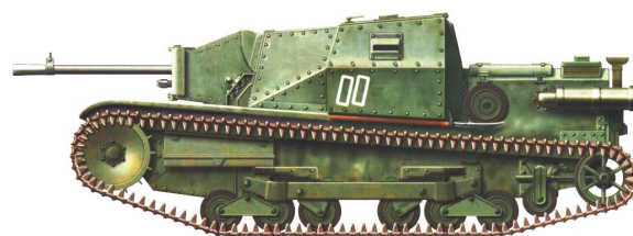
Protótipo construído pelos espanhóis em agosto de 1937, um CV.35 armado com um canhão de 20 mm.
