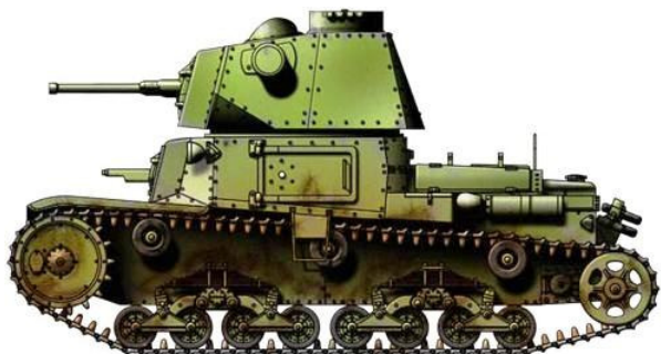
M13/40 com torre de telemetria. Chamado de Veicolo Di Osservazione Dell'Artiglieria (Veículo de Observação de Artilharia), ele se destinava a dirigir o fogo das unidades de canhões autopropulsados. Ele era idêntico ao M13/40 normal, exceto pela torre, que era equipada com um telêmetro e seu canhão era falso. Não foi produzido em série.
