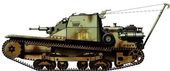
L3 Recupero, versão de guincho para recuperação de veículos avariados, 312º Batalhão de Tanques, Creta, maio de 1941.
