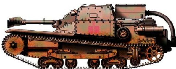
L3/35 Lança-chamas com reservatório acoplado. Trata-se do 2º tanque do 1º Pelotão, 1ª Companhia, 4º Regimento de Tanques, Forte Tiburtino, Roma, 1941-42.
