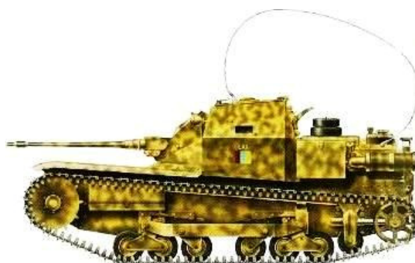
L3/33 versão de comando, equipado com rádio e armado com um canhão antitanque Solothurn S18-1000 de 20 mm, Bardia, Líbia, 1941.
