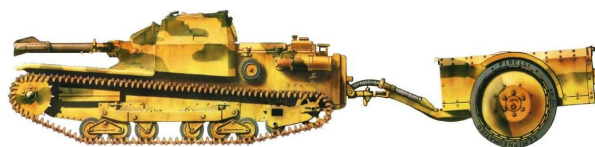
L3/33 Lança-chamas com reservatório em reboque, Divisão Ariete, Líbia, 1941.
