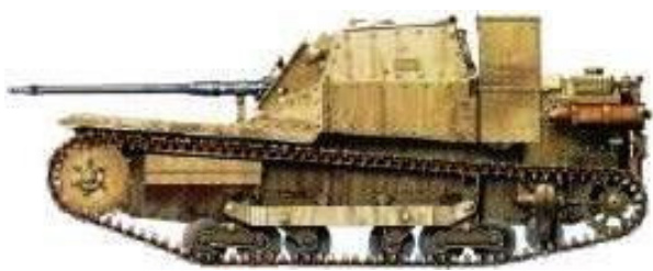
L3/35 armado com um canhão antitanque Solothurn S18-1000 de 20 mm, África do Norte, início de 1941.
